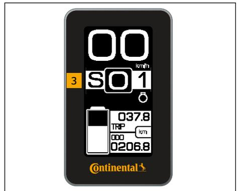
Abb.: Display Unterstützungsstufe 0
