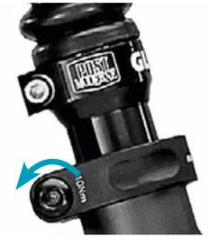
zu 1. Sattelschraube(n) lösen.
