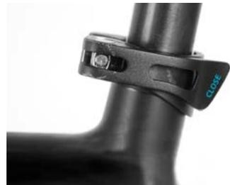
zu 2. Schnellspannhebel geschlossen
