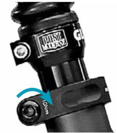
zu 3. Sattelschraube(n) festziehen.
