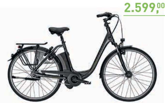
KALKHOFF TASMAN IMPULSE 8 Impulse Evo 250W Mittelmotor; Akku 36V-17Ah/612Wh Shimano 8-Gang „Nexus“ Nabenschaltung mit Freilauf Gefederte Sattelstütze und SR Suntour Federgabel für optimalen Komfort
