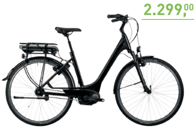
CUBE TRAVEL HYBRID 400 Bosch Active Antrieb 36V/400Wh 7-Gang Nabenschaltung Hydraulische Magura Felgenbremsen HS11
