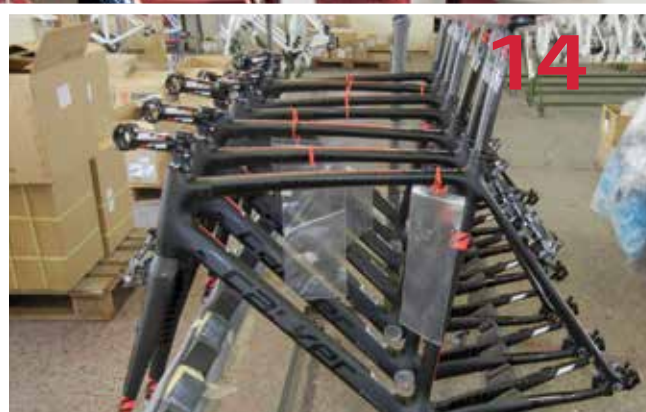
>> GUT GEBAUT Stück für Stück wächst das Fahrrad. Hier sind bereits Gabel, Vorbau, Bremsen, Schaltwerk und Sattelstütze nebst Sattel montiert.
